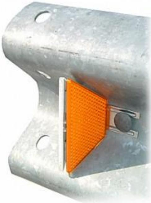
El producto se compone de un elemento retro reflectante plástico de esquina de cubo, encapsulado entre una carcasa traslúcida de alta resistencia y una base en ABS, que lo protegen. El elemento catadióptrico queda unido a una base metálica (acero galvanizado) de igual superficie mediante diferentes sistemas de sujeción.
