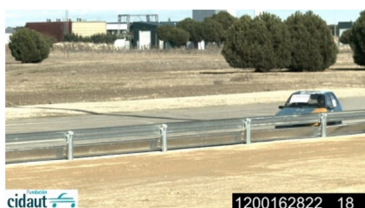
Ensayo: TB11 (900 kg, 100 Km/h y 20°)
