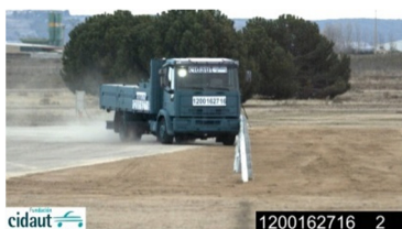
Ensayo: TB42 (10 Tm., 70 Km/h y 15°)
