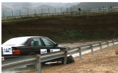
Essai: TB32 (voiture 1.500 Kg., 110 Km/h., 20°)
