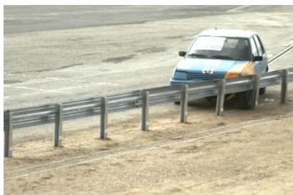
Essai: TB11 (voiture 900 Kg., 100 Km/h., 20°)
