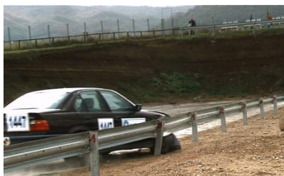
Test: TB32 (car 1.500 Kg., 110 Km/h., 20°)
